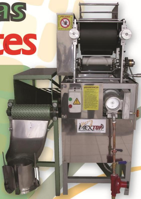
\* El consumo de gas, depende del equipo adquirido y de factores externos al mismo como son: La humedad de la mása, la temperatura ambiente, el tipo de producto a elaborar y la carburación de la máquina tortilladora.
